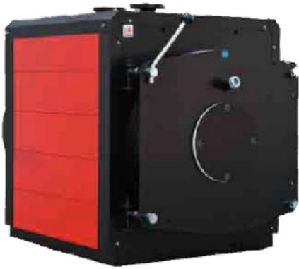
Котёл из стали, модель ALPHA R 7-130, с топкой с реверсивным развитием факела цилиндрической формы, топка полностью закрыта в задней части выпуклым днищем, поддерживаемым оmyваемым патрубком. Совместим с горелками с наддувом воздуха для работы на жидком или газообразном топливе. Предназначен для использования в системах с температурой воды от 55 до 110°C (предохранительный термостат настроен на 115°C).
