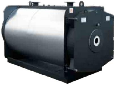
Котёл из стали, модель ALPHA R 140-350, с топкой с реверсивным развитием факела цилиндрической формы, топка полностью закрыта в задней части выпуклым днищем, поддерживаемым оmyваемым патрубком. Совместим с горелками с наддувом воздуха для работы на жидком или газообразном топливе. Предназначен для использования в системах с температурой воды от 55 до 110°C (предохранительный термостат настроен на 115°C).
