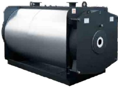
Котёл из стали, модель ALPHA R 400-600, с топкой с реверсивным развитием факела цилиндрической формы, топка полностью закрыта в задней части выпуклым днищем, поддерживаемым оmyваемым патрубком. Совместим с горелками с наддувом воздуха для работы на жидком или газообразном топливе. Предназначен для использования в системах с температурой воды от 55 до 110°C (предохранительный термостат настроен на 115°C).
