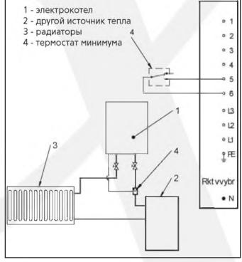
Трёхходовой клапан должен иметь микровыключатель. Микровыключатель нужно подсоединить на клеммы 1,2. Микровыключатель будет включен, когда идёт нагрев ГВС.
